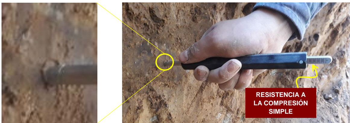
FIGURA 4.d.- USO DEL PENETRÓMETRO EN LA PARED DE UN POZOA CIELO ABIERTO
