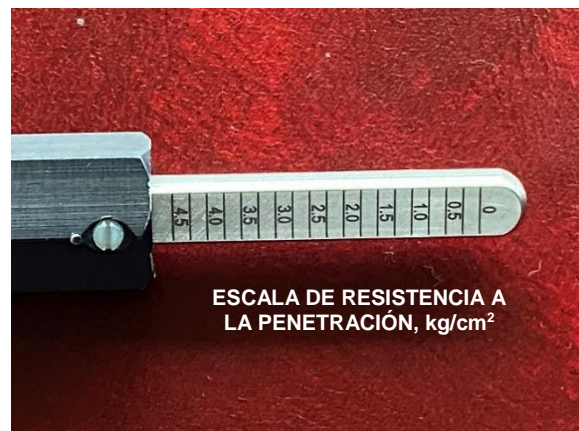
FIGURA 4.c.- RESISTENCIA A LA PENETRACIÓN, QUE REPRESENTA LA RESISTENCIA A LA COMPRESIÓN SIMPLE
